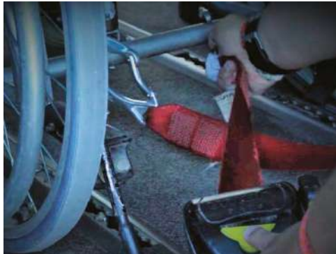
Figura 12. Anclajes de la silla de ruedas al vehículo
